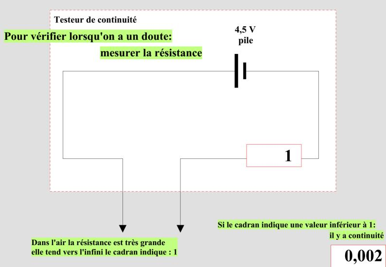
1- Le circuit testé en continuité ne doit pas être sous tension
