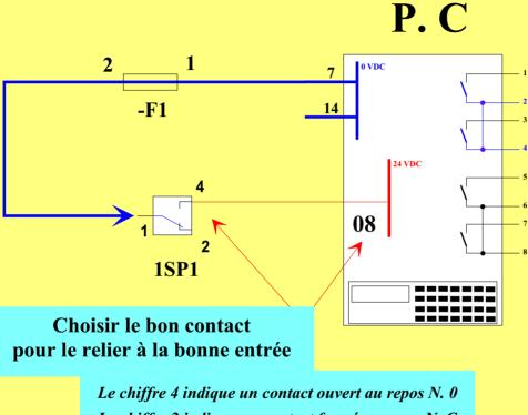
Le chiffre 2 indique un contact fermé au repos N. C
