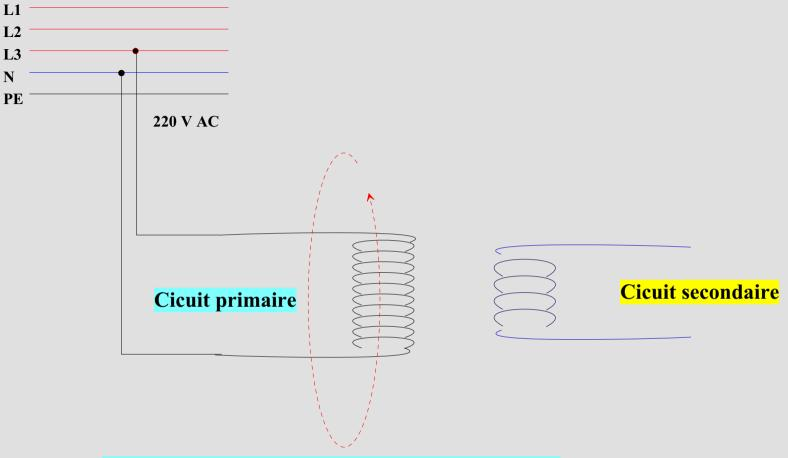
Un bobinage sous tension crée un champs magnétique. On forme ainsi un électro aimant Si primaire et secondaire sont reliés par des tôles fines le champs magnétique se transmet au secondaire
