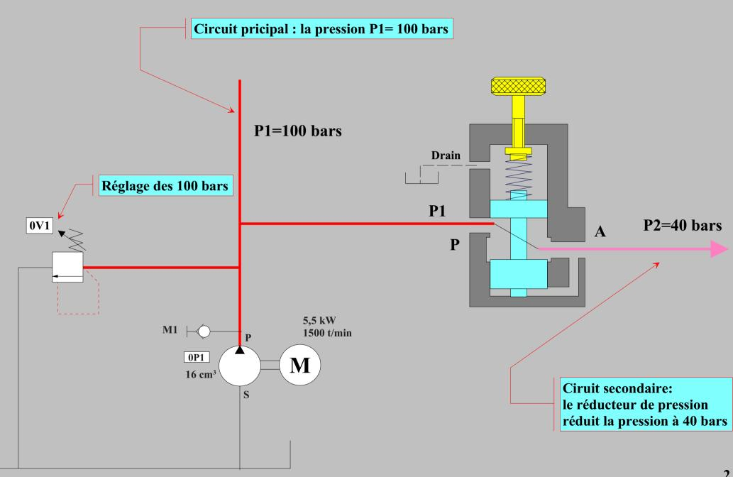
Les limiteurs de pression eux sont de type N.F Normalement Fermé
