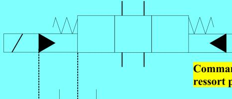
Commande par électro aimant et pilote hydraulique, ressort prinicpal centré, alimentation et drains externes de pilotage
