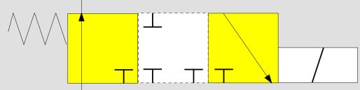
Trois orifices, deux positions distinctes, une position intermédiaire principale, commandé par électro-aimant et ressort de rappel
