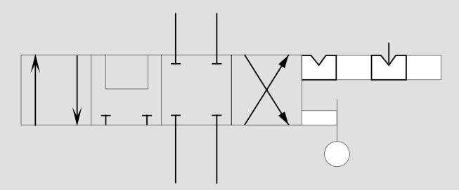
Les dispositifs de maintien en position doivent être dessinés avec méme nombre de cases et dans même ordre que l'élément commandé. Les encoches ne sont représentées que dans les positions d'immobilisation. Dessiner le symbole du poussoir dans la position correspondant à l'unité représentée
