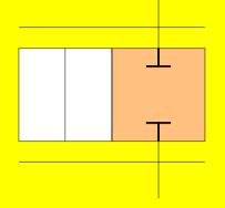
Deux orfices, fermé en position de repos, passage variable
