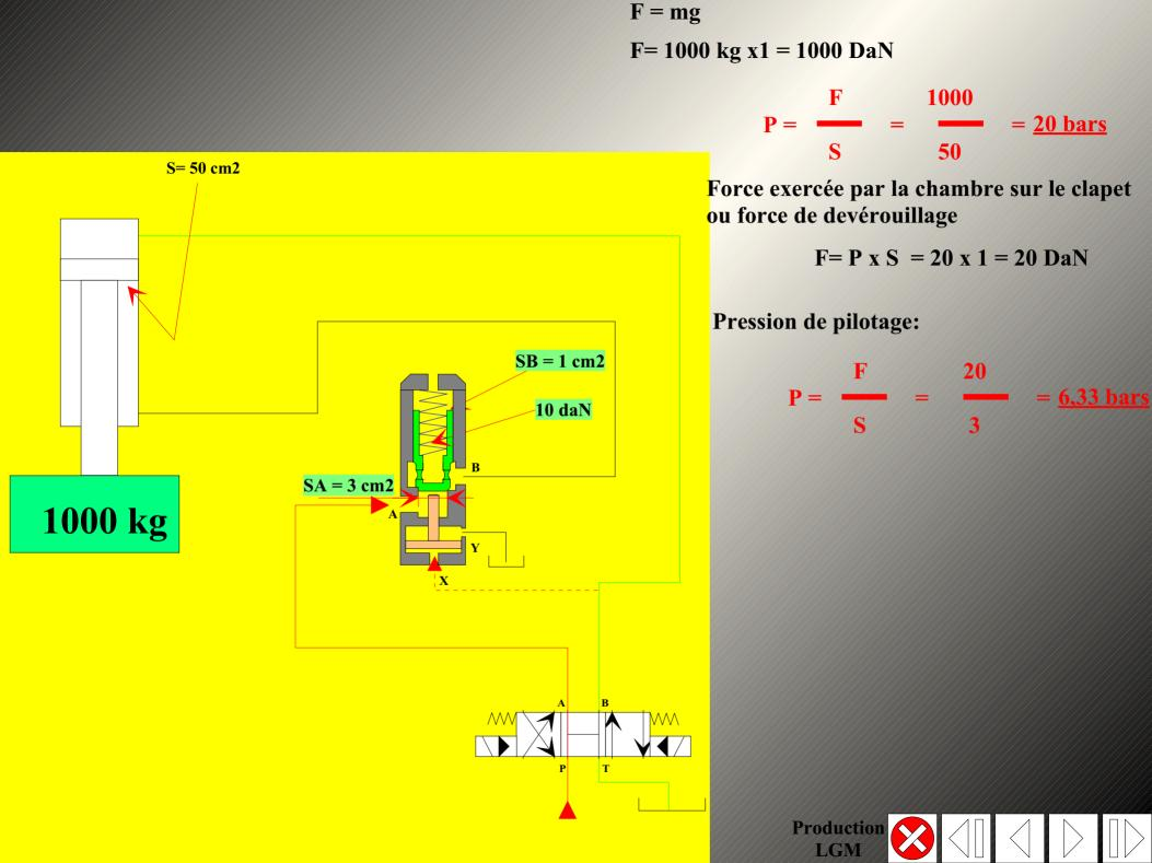
Lorsque le clapet s'ouvre : le vérin rentre
