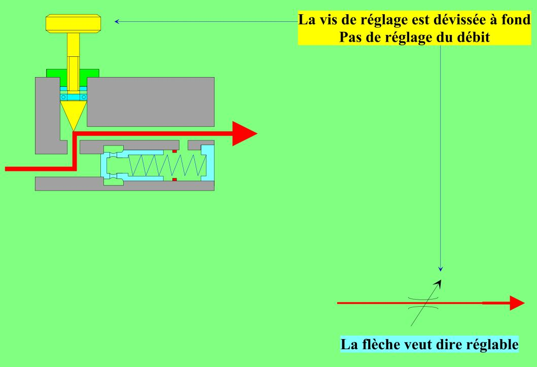
Si on visse, le pointeau crée une résistance au passage du fluide
