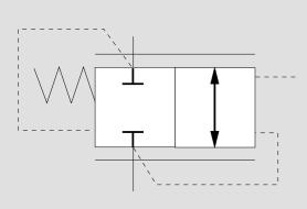
Clapet de non retour avec ressort de rappel, il est possible de l'ouvrir par pilotage.
