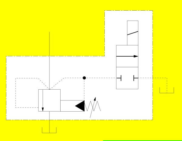
Limiteur de pression à commande électrique
