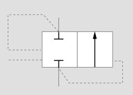
Clapet de non retour piloté, possibilité de fermer le clapet sans ressort de rappel.
