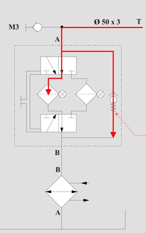
Quand la pression est supérieure au tarage du ressort du clapet le fluide retourne au réservoir sans être filtré
